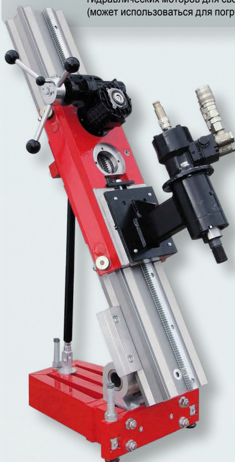
В600 со шпинделем В300, гидравлическим мотором OMR 300 и шарниром (опция)
